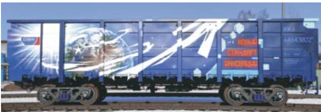
Второе поколение инновационных грузовых вагонов ПАО «НПК ОБК» – полувагон с разгрузочными люками 12-6744 в парадной лифрее для запуска производства
