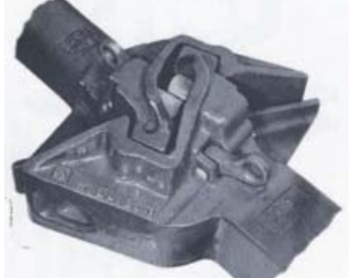
Автоматическая сцепка вагонов Виллисона
