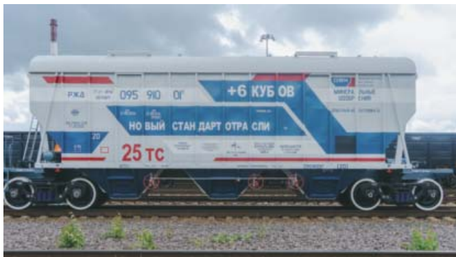
Второе поколение инновационных грузовых вагонов ПАО «НПК ОБК» – вагон-хоппер для минеральных удобрений 19-9591 на выставке PROДВИЖЕНИЕ ЭКСПО
