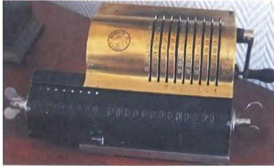
Техническое обеспечение трудоемких расчетов поначалу полностью отсутствовало. Первым отечественным устройством, облегчившим и ускорившим процесс расчетов, стал **арифмометр Однера**, производство которого было налажено в Санкт-Петербурге в 1890 г.
